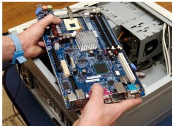
Placa base antes de ser instalada en un ordenador.
